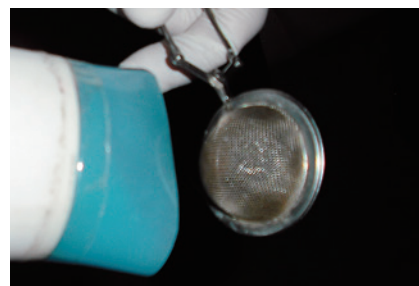
3-6 セラミックプライマーⅡ塗布後に加熱処理を行う。加熱処理を行ったほうがより接着する。
