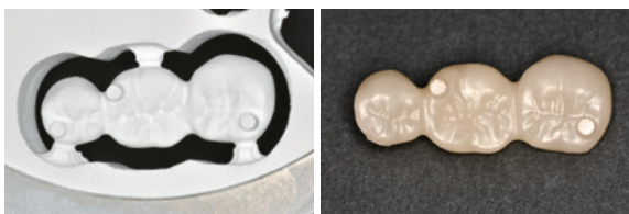
2-11 加工が終了した状態（左）。各調整後、着色材にて着色し、シンタリング後の無調整の状態（右）。咬合面を加工する際、半径0.3mmのバーを使用することによってかなり細部までの加工が可能となった。
