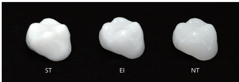
図3 Aadvaジルコニアディスクの光透過性の違い。(左より、ST・EI・NT)。ST(スタンダード)に比べ、やや光透過性の高い中透過タイプのEI(エナメルメンテナンス)に加え、新たに高透過タイプNT(ナチュラルトランスルーセント)がラインナップされた。NTは高い光透過性を備えており、自然感のあるフルジルコニアクラウンの製作が可能である。
