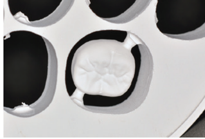
1-14 AadvaミルLD- I による加工が終了した状態。加工時間は約50分程度で終了する。
