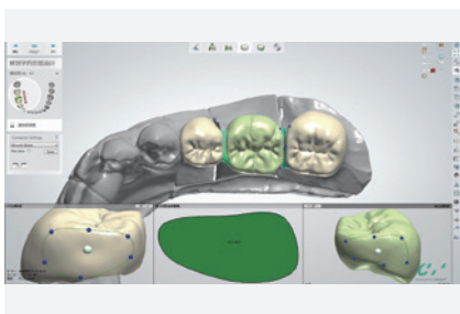
2-9 最後に連結部を付与する。ブリッジ連結部の面積はNTで臼歯部は17mm 2 必需である（図2-2参照）。
