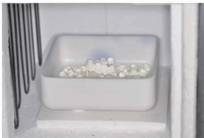
1-16 焼結の際には、ジルコニアボールやアルミナボールを敷き詰め、収縮の干渉が少なく、素直に均等な収縮をさせる工夫が必要である。
