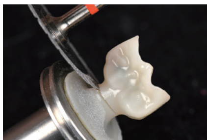
1-4 レストカット。材料に強度があるとはいえ、局所的に熱を加えるとクラックが入る恐れがあるため、注水下か水分を含ませたティッシュなどで補綴装置を保護しながら、最終外形から1～1.5mmほど離れたところからカットする（マイジंगाーダイヤモンドディスク DM915DF）。
