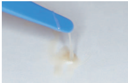
図13 使用説明書に従い粉末と液を採取し、20~30秒でしっかりと練り上げる。練り上がりは垂れにくい流動性である。
