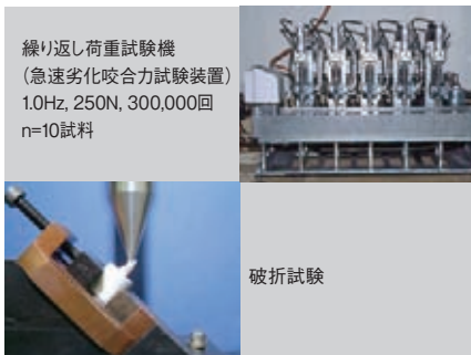
図5 試験体製作後、破折試験を行なった条件と繰り返し荷重試験機にて繰り返し荷重を負荷したのちに破折試験を行なった条件の2条件を設定した。
