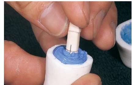
4-3 ジーシー エクザミックスファインはフローも良く操作時間も充分なので、細部にもきちんと流れる。また硬化後も柔らかいので撤去時の模型のチップの恐れがない。
