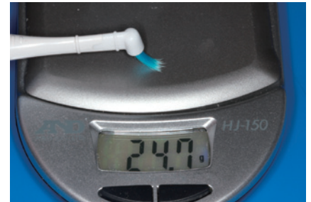
4-3 秤の上でペリオブラシに最適プロービング圧(20~25g)と同程度で力を加えた。ブラシの先端は容易に曲がり、歯周ポケット内でも同じようにしなり歯周組織に対して破壊的に力が及ばないことが推測された。ペリオブラシのテーパー毛は、歯周ポケット、インプラント周囲溝に容易に挿入しやすい特長があるため、挿入深度には充分注意する必要がある。
