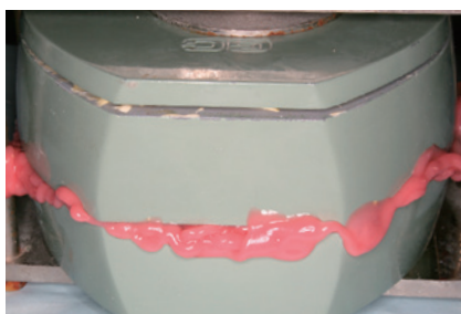
4-14 上・下のフラスコを嵌合させ、室温で約30分程度保持する。
