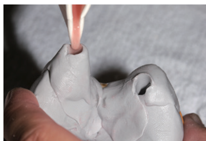
4-2 「ラボコーンパテ」は、硬化後適度な硬度を持つ特性であるので、作業中も安心である。
