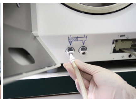
3-14、15 チャンバー内は清潔に保ち、廃水処理を行わないと故障の原因になる。
