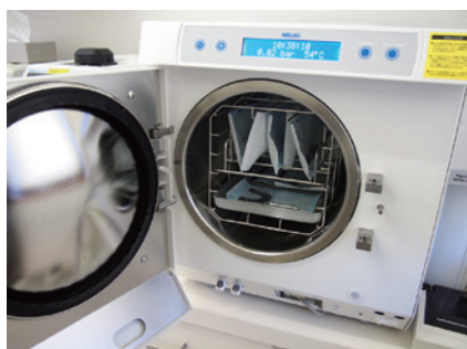
3-13 チャンバー内に蒸気が適切に行き渡るようにするため、器材の詰め込みすぎは禁物。
