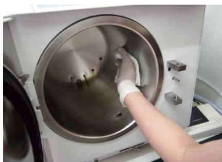
3-14、15 チャンバー内は清潔に保ち、廃水処理を行わないと故障の原因になる。
